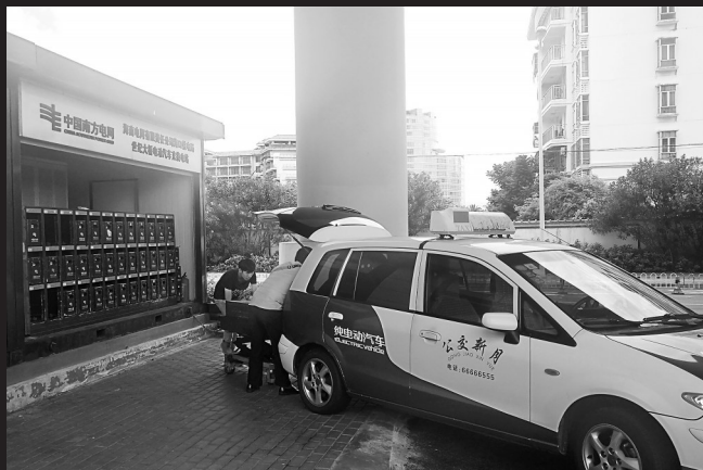
出租车正在换电池。
